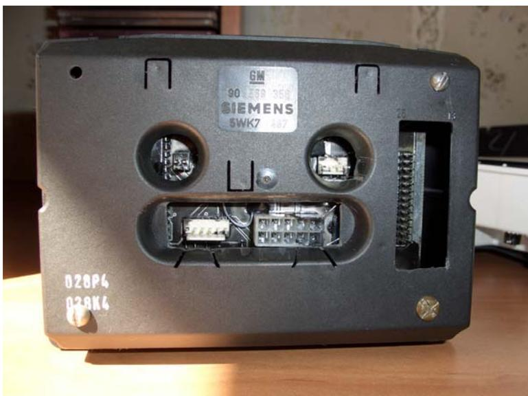
Вставляем опилевский разъем в бк **вверх проводами**, т.е. не так, как в штатный. При этом экран бк должен засветится, должны работать кнопки, идти часы, работать измерения напряжения, температуры, скорости.
