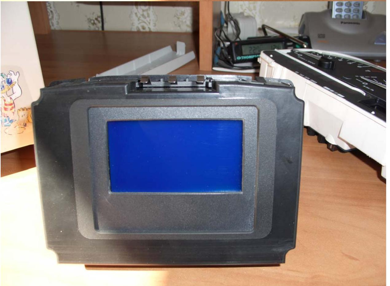
Собираем корпус, предварительно одев разъемы экрана и кнопок.
