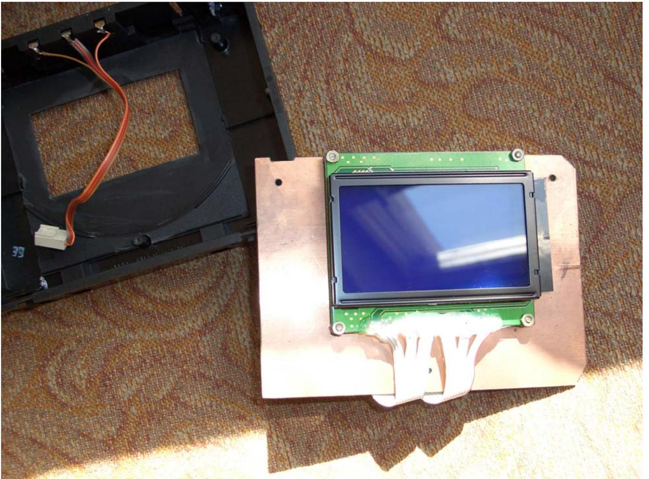
Подобрана пластинка (в данном случае – из стеклотекстолита), на которую на стойках крепится экран, пластинка крепится к корпусу.
